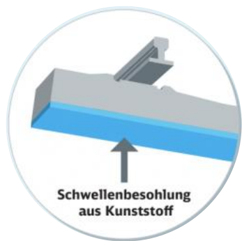
Masse-Feder-System mit elastischer Kunststoffmatte
