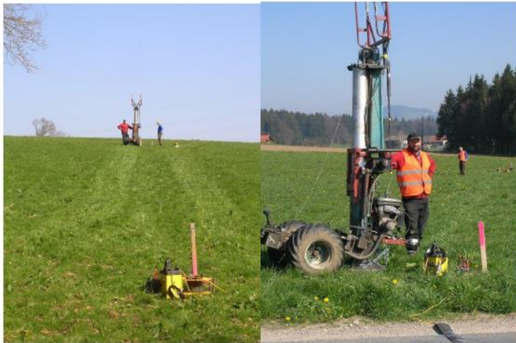
Abbildung 1: Seismische Quelle VAKIMPAK und Aufnehmer mit Verkabelung
